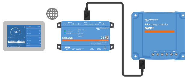
Connexion à l'application VictronConnect à travers le réseau LAN ou Internet (portail VRM) en utilisant un appareil GX (par exemple un Cerbo GX)
