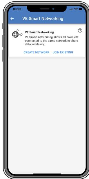
Le réseau VE.Smart permet à une variété de produits connectés au même réseau de partager leurs données par Bluetooth. Le réseau VE.Smart est spécialement conçu pour des systèmes de plus petite taille qui ne disposent pas d'un dispositif GX.
