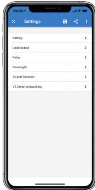
Pour accéder aux paramètres du chargeur solaire, parcourez la page de Configuration. Pour cela, cliquez sur l'icône en forme de roue dentée
