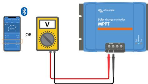
2. Mesurez la tension de la batterie sur les bornes de la batterie en utilisant un multimètre.
