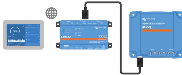
Connexion à l'application VictronConnect à travers le réseau LAN ou Internet (portail VRM) en utilisant un appareil GX (par exemple un Cerbo GX)
