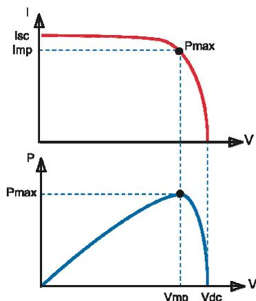
**Maximum Power Point Tracking (Localisation du point de puissance maximale)**
