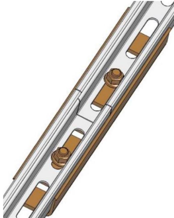
Posez les extrémités de rail bord à bord. Insérez au centre le raccord de rail et le fixer au rail à l'aide des vis de fixation fournies dans le kit. Les raccords ainsi que le nombre de vis dépendent du rail.
