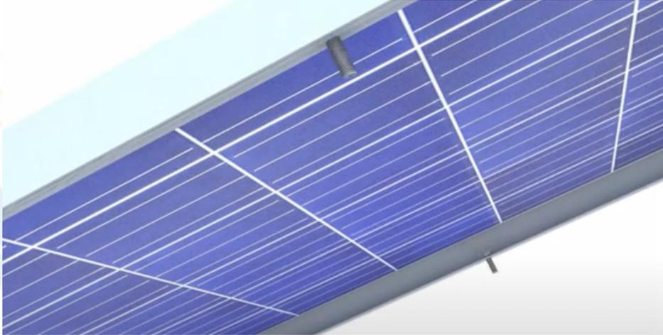
Positionnez deux vis anti-glissement dans les œillets du panneau. Si vous avez deux rangées de panneaux. Seule la rangée du bas aura besoin de vis anti-glissement
