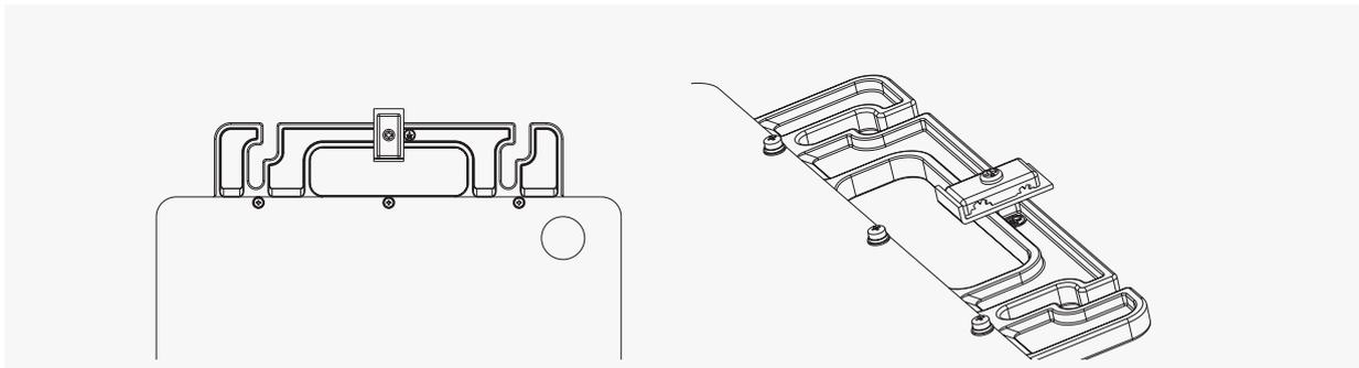
Acheminez un câble de mise à la terre continu à travers les supports de mise à la terre de chaque micro-onduleur jusqu'à l'électrode de mise à la terre CA conforme à la réglementation locale.
