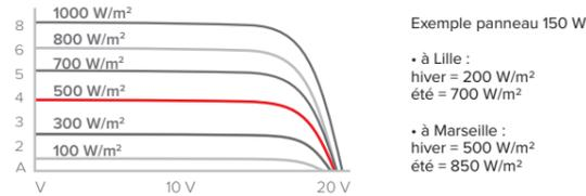
Un panneau solaire produira avec un ensoleillement hiver à Marseille (=500W/m<sup>2</sup>) soit 50% de sa puissance.
