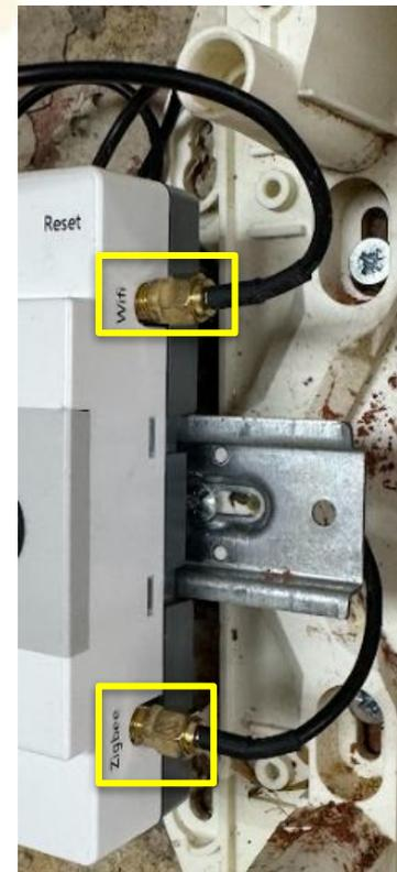
Connectez les antennes Wi-Fi et ZigBee sur la passerelle.
