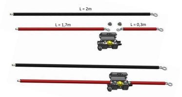
Kit batterie n°1: Ajoutez les cosses à l'aide de l'écrou papillon. Vous pouvez si besoin fixer le portefusible à l'aide de la vis autotaraudeuse fournie.
