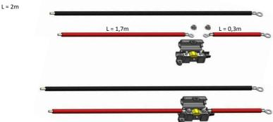
Kit batterie n°2: Ajoutez les cosses à l'aide de l'écrou papillon. Vous pouvez si besoin fixer le portefusible à l'aide de la vis autotaraudeuse fournie.
