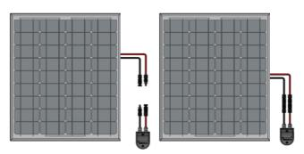
nb : Pour la connexion panneau, retirez les bouchons situés à l'extrémité de vos câbles. Gardez-les précieusement afin de protéger vos câbles lorsque vous déconnectez vos panneaux pour vos opérations de maintenance ou de nettoyage par exemple.
